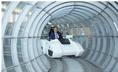
这条多功能高温超导磁悬浮环形试验线是世界首条，被称为中国版“超级高铁”雏形，理论时速600-1000公里/小时，动力来源于低至零下196摄氏度的液氮，是自然界唯一能实现的无源稳定悬浮技术。
